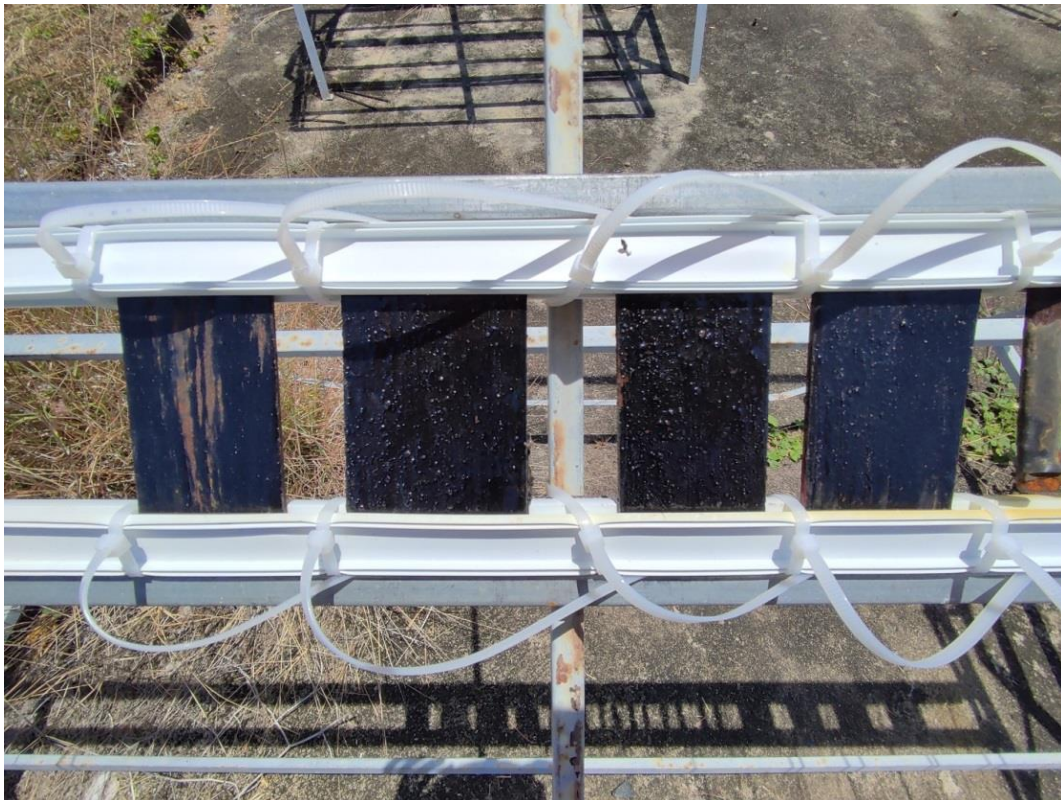
Hình 4a. Mẫu sơn thử nghiệm, các mẫu theo thứ tự từ trái qua phải PS4, PS3, PS2, PS1
