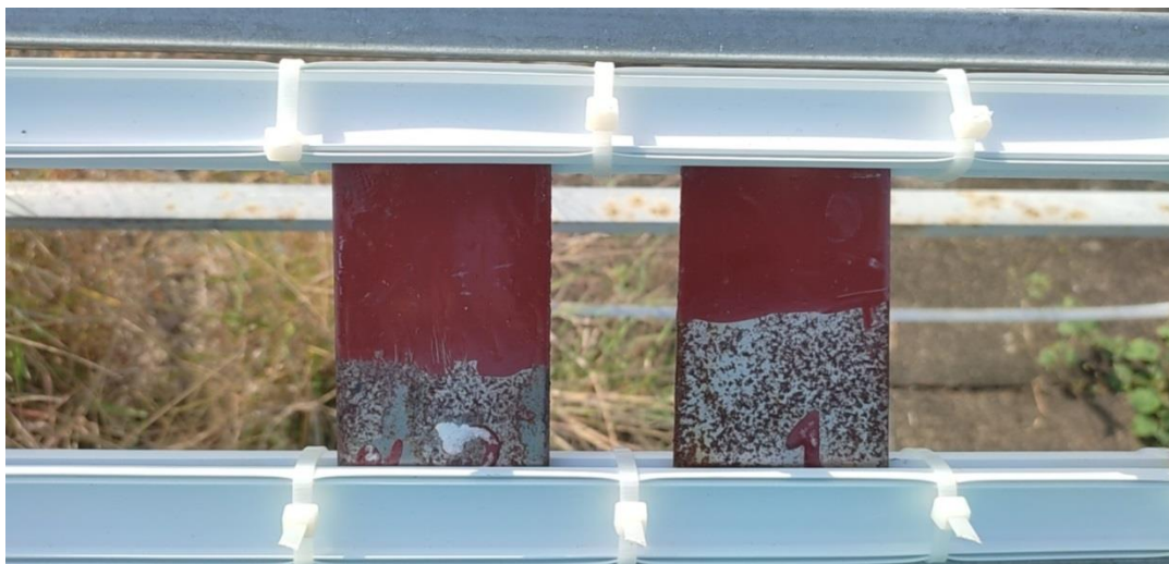
Hình 4b. Mẫu sơn đối chứng, các mẫu theo thứ tự từ trái sang phải PS6, PS5
