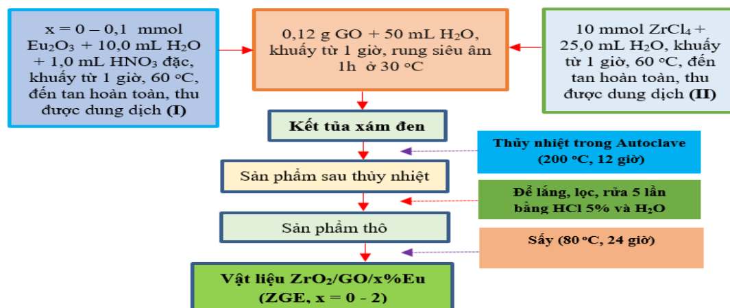
Hình 1. Quá trình tổng hợp vật liệu ZrO_2/GO/x\% mol Eu^{3+} bằng phương pháp thủy nhiệt.
