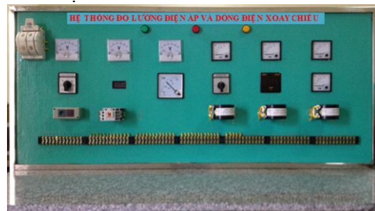
Hình 1: Module 1 sơ đồ lắp ráp và bàn thực hành đo lường điện áp và dòng điện xoay chiều
