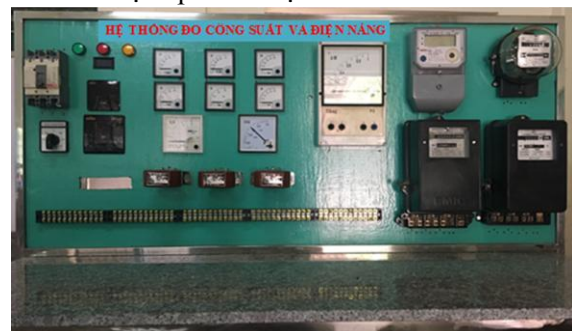
Hình 3: Module 3 sơ đồ lắp ráp và bàn thực hành đo công suất, tần số, \cos\phi và điện năng
