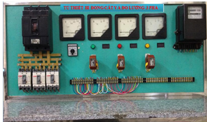
Hình 5: Module 5 bàn thực hành lắp tủ thiết bị đóng cắt và đo lường ba pha
