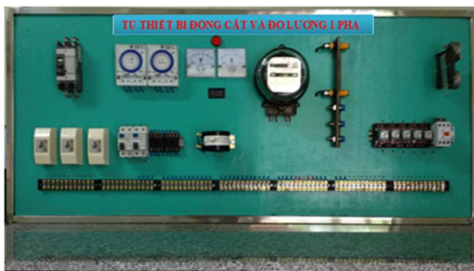
Hình 4: Module 4 bàn thực hành lắp tủ thiết bị đóng cắt và đo lường một pha
