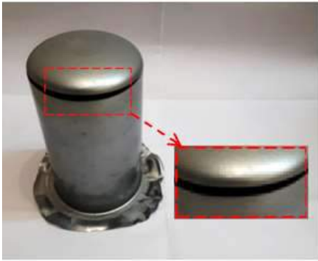
Hình 7. Kết quả thực nghiệm dập sâu chi tiết cốc lọc nhiên liệu bị rách
