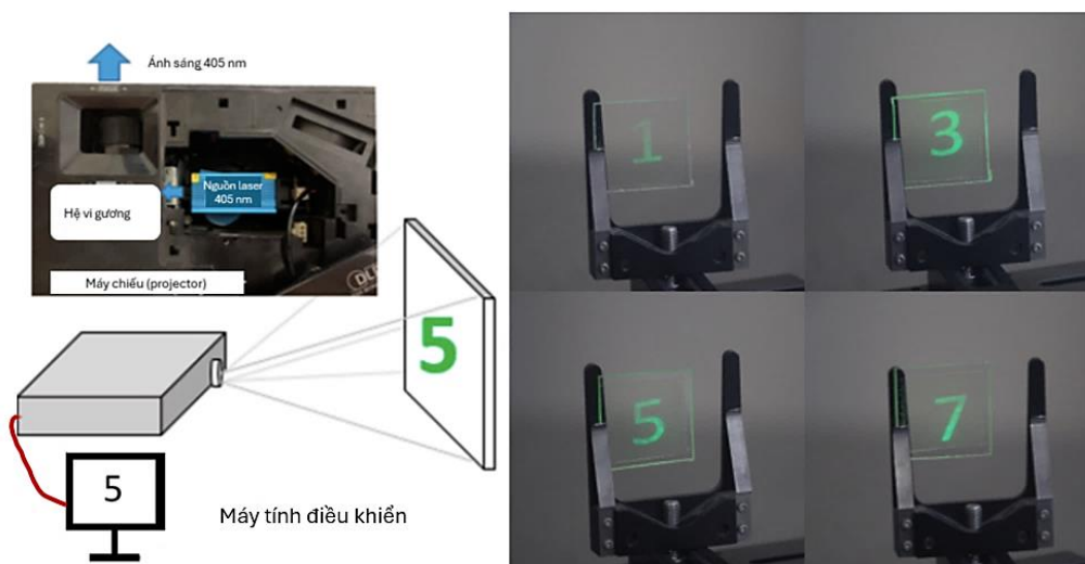
Hình 7. Hình ảnh chụp thực tế của tấm phát quang trong suốt sử dụng nguồn kích thích là máy chiếu laser 405 nm
