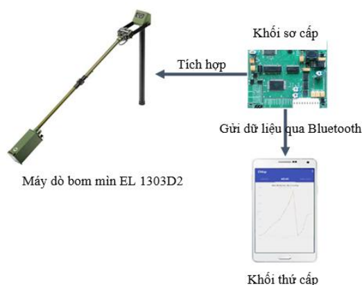
Hình 3. Mô hình hệ thống máy dò bom EL1303D2 và bộ thiết bị nhúng
