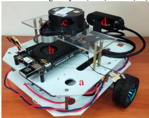
Hình 4. Robot di động và các ngoại vi: a) khung robot, b) máy tính nhúng Latte panda 3, c) Lidar lds-006, d) máy ảnh Intel D453i
