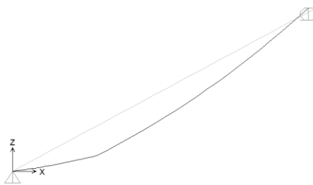
Hình 3. Biến dạng của dây neo trong trường hợp có một vật treo
