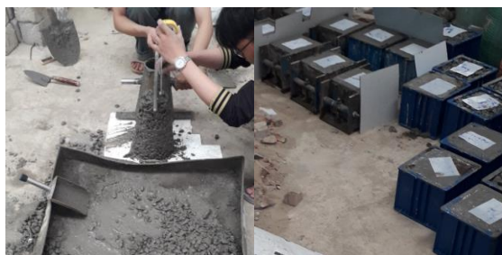
Hình 7. Thí nghiệm xác định độ sụt của hỗn hợp bê tông và đúc mẫu khối lập phương
