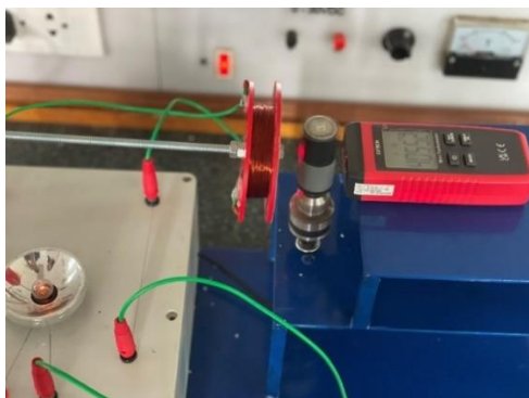
Hình 9. Ảnh chụp hiệu ứng phát sáng của bóng đèn khi cho nam châm quay tới tốc độ 4052 vòng/phút (cuộn dây có kích thước 350 vòng, đường kính 51,9 mm)
