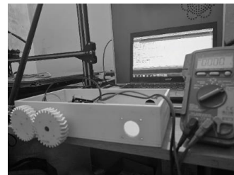
Hình 7. Sơ đồ thí nghiệm đo độ ồn và điện năng tiêu thụ
