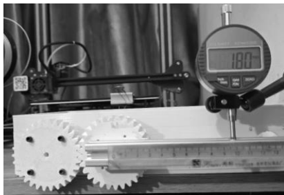
Hình 6. Sơ đồ thí nghiệm đo độ rơ của cặp bánh răng
