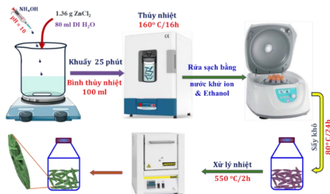
Hình 1. Mô hình minh họa quy trình chế tạo thành nano/micro ZnO có cấu trúc xốp
