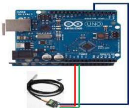
Hình 1. Sơ đồ nguyên lý mạch cảm biến nhiệt độ dùng DS18B20
