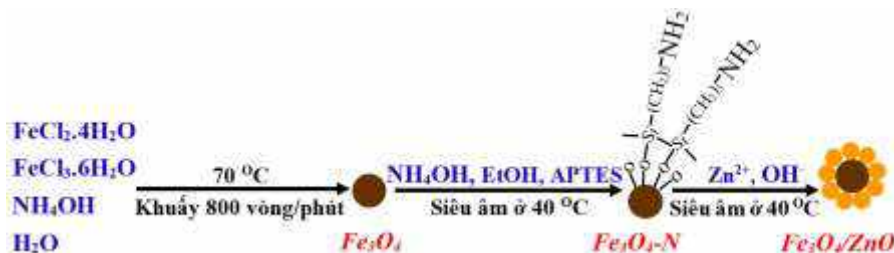
Hình 1. Quy trình chế tạo hạt nano composit \text{Fe}_3\text{O}_4/\text{ZnO}
