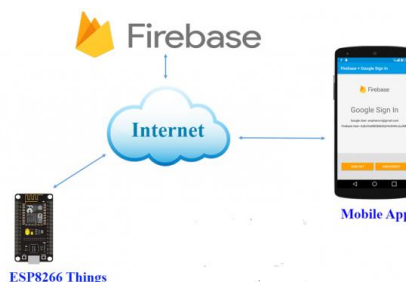
Hình 10. Sơ đồ kết nối dữ liệu Firebase
