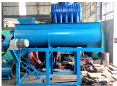
Hình 12. Máy trộn sau chế tạo
