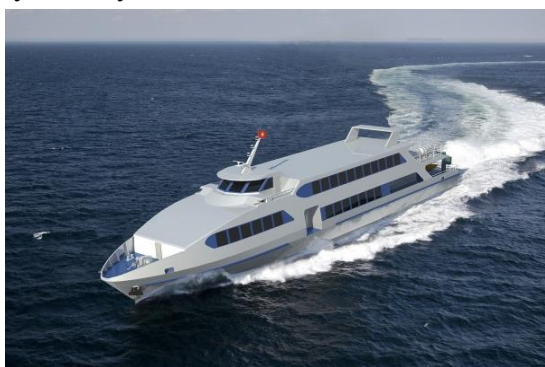
Hình 1. Tàu khách vỏ nhôm Việt Nam ( L \times B \times T = 41.12 \times 5.6 \times 1.25 \text{m} ; 310 khách; máy chính 2 \times 1500 \text{HP} ; tốc độ 27 \text{knots} )
