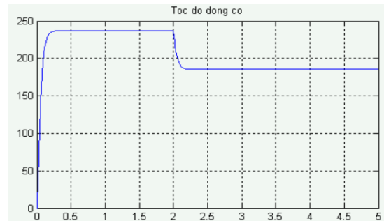
Hình 4. Kết quả mô phỏng tốc độ động cơ
