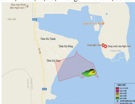
Hình 2. Hành vi di chuyển của các vết dầu loang sau 0,5, 1, 2, 3 và 6 giờ sau khi xảy ra sự cố vào mùa gió Đông Bắc (vận tốc gió 9,5m/s, hệ số khuếch tán ngang \zeta = 0,15\text{m}^2/\text{s} )
