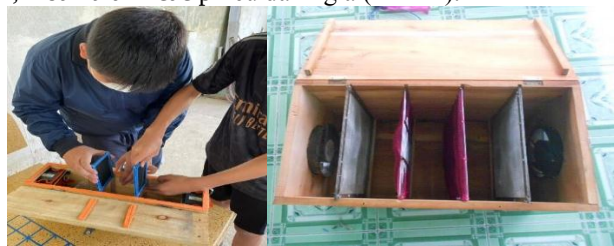
Hình 1. Thiết bị lọc không khí do HS thiết kế, lắp ráp
