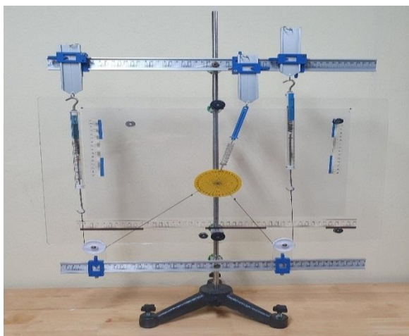
Hình 4. Vật biến dạng dưới tác dụng của hai lực đồng quy
