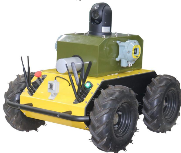
Hình 6. Hình ảnh tích hợp hoàn chỉnh hệ thống cơ khí và truyền động của robot
