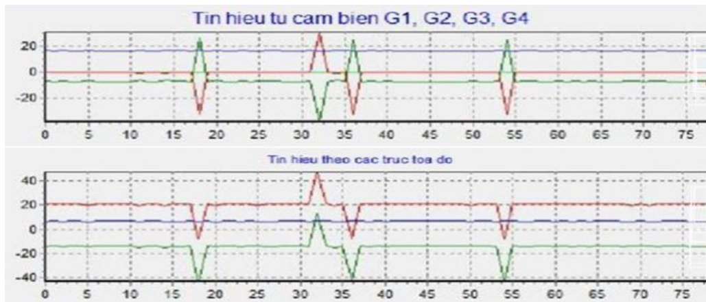
Hình 6. Thí nghiệm cảm biến G_1 hỏng do mất tín hiệu
