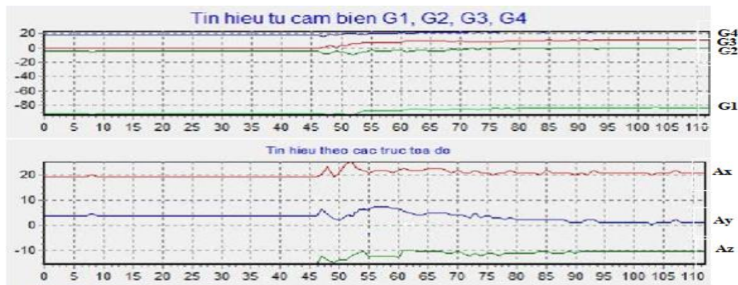
Hình 8. Thí nghiệm cảm biến G_1 hỏng do trôi âm
