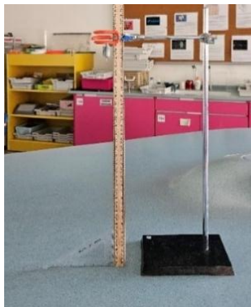
Hình 5. Bố trí thí nghiệm đo độ biến dạng của lò xo
