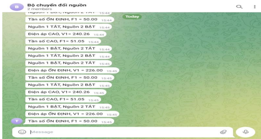
Hình 8. Thông báo các trạng thái và sự cố bộ chuyển đổi nguồn trên Telegram
