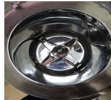
Hình 2. Cấu tạo buồng máy trộn tốc độ cao có gia nhiệt
