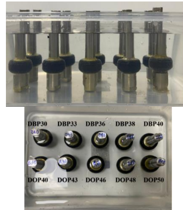
Hình 6. Hình ảnh các mẫu bầu thuốc đen được phủ các mẫu keo chế tạo được ngâm trong nước sau 24 giờ
