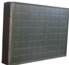
Hình 1. Chày trên khuôn ép gạch Ceramics của nhà máy Mikado Thái Bình
